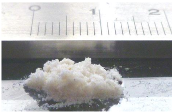
Abgeschabtes von der Glasplatte Bienengift nach einer Session von einem Bienenstock. Sie sehen 2 cm von der Skala.
